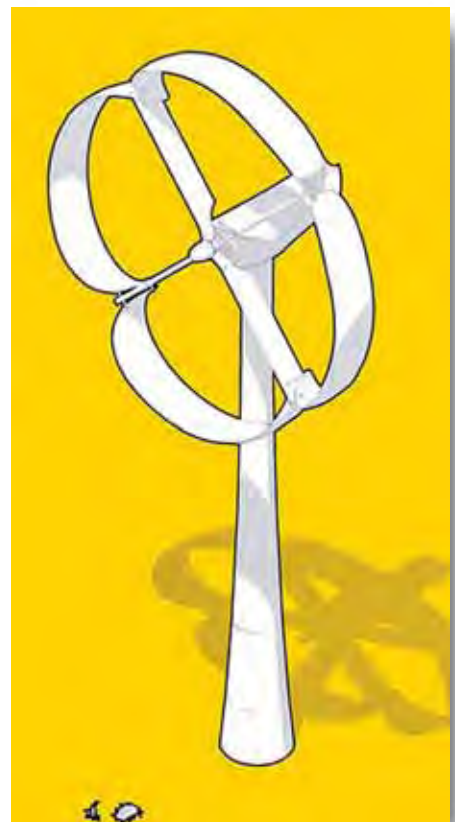
Gedayc, un prototipo cuyo nombre es el acrónimo de Generador Eólico De Aspas Y Cometas.
